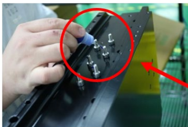
Afb. 5.15: Gebruik een niet-magnetisch tool om de stator te installeren
