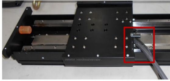
Afb. 6.7: De verlengkabel is niet in de kabelketting gestoken
