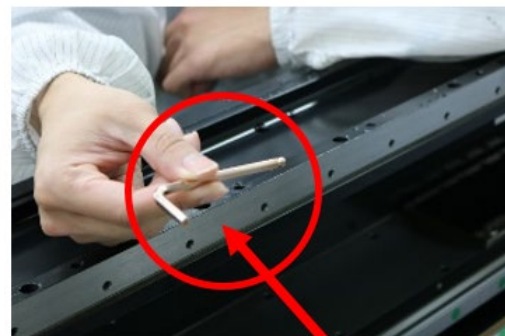
Afb. 5.15: Gebruik een niet-magnetisch tool om de stator te installeren
